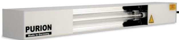
Dieses Gerät besteht aus einem matt eloxierten Aluminiumprofil mit passenden Abdeckblechen. Das Strahlerfach ist mit einem Reflektor aus reinst polierten Aluminium ausgelegt. Im rückseitigen Teil befinden sich die Verkabelung und das elektronische Vorschaltgerät.
