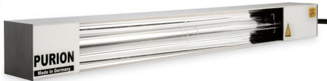
Dieses Gerät besteht aus einem matt eloxierten Aluminiumprofil mit passenden Abdeckblechen. Das Strahlerfach ist mit einem Reflektor aus reinst polierten Aluminium ausgelegt. Im rückseitigen Teil befinden sich die Verkabelung und das elektronische Vorschaltgerät.
