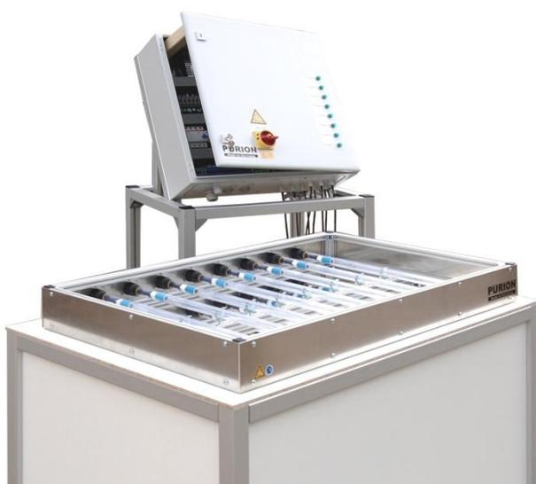
Das PURION UV MODUL 1400 besteht aus einem Aluminiumgehäuse welches in Desinfektionsrichtung offen ist. Die PURION UV MODUL 1400 kann über oder unter dem zu desinfizierenden Bereich installiert werden. Damit ist es z.B. für die Banddesinfektion sehr gut geeignet.
