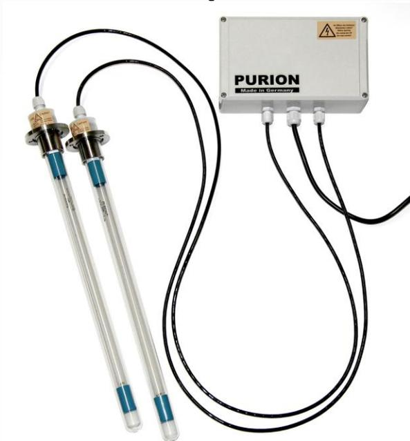
Dieses UV-Set DUAL besteht aus zwei einseitig verschlossenen Quarzschutzrohren, welche am anderen Ende in einem Edelstahlflansch gelagert sind, zwei UV-Strahlern, einem Schaltkasten mit elektronischen Vorschaltgerät und den Verbindungskabeln.
