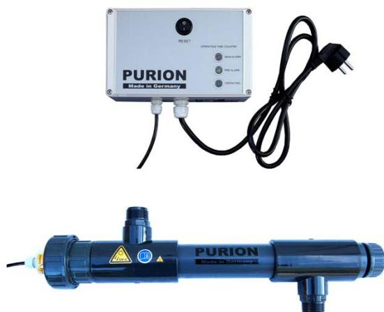
Die Anlage PURION 1000 ist in PVC-U ausgeführt. Sie findet Anwendung bei der Wasserentkeimung für Durchflussleistungen bis 1.000 l/h und einer Transmission (oder auch Trübung) des Wassers von mindestens 90% pro cm. Weitere Einsatzgebiete sind unter anderem Pools und Fischteiche bis zu einer Größe von 10.000 l bei stetiger Umwälzung.
