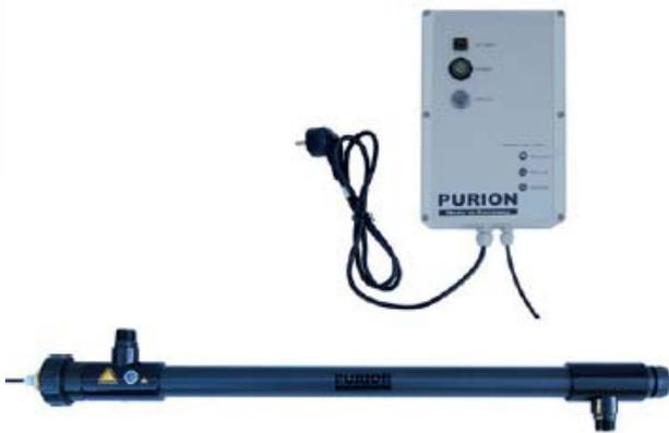
Die Anlage PURION 2500 36 W ist in PVC-U ausgeführt. Sie findet Anwendung bei der Wasserentkeimung für Durchflussleistungen bis 3.000 l/h und einer Transmission (oder auch Trübung) des Wassers von mindestens 90% pro cm. Weitere Einsatzgebiete sind unter anderem Pools und Fischteiche bis zu einer Größe von 20.000 l bei stetiger Umwälzung.
