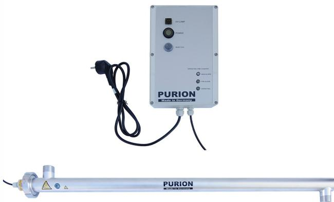
Die Anlage PURION 2500 90 W ist in elektropolierten Edelstahl ausgeführt. Sie findet Anwendung bei der Trinkwasserentkeimung für Durchflussleistungen bis 4.000 l/h und einer Transmission (oder auch Trübung) des Wassers von mindestens 90% pro cm.
